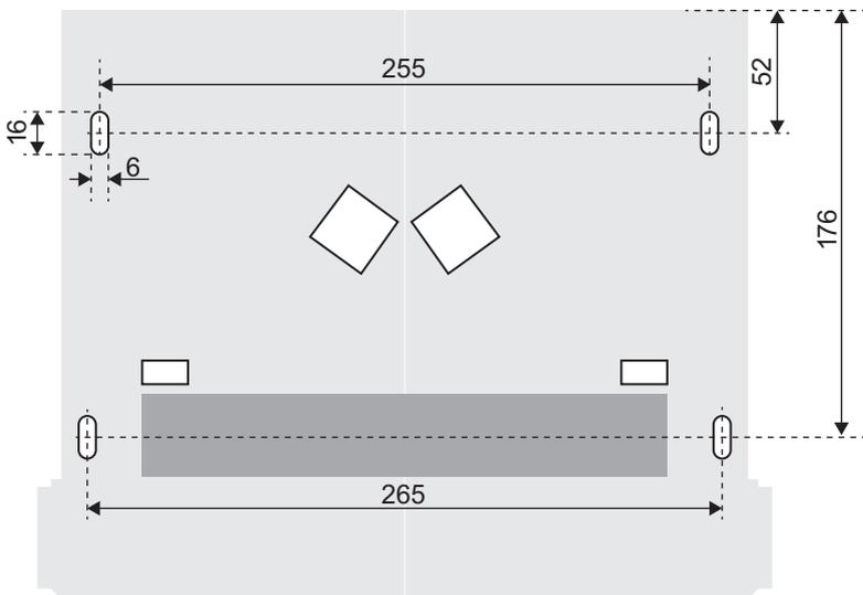
**Abmessungen und Montageskizze Profi-Umluft-Modul 3**
