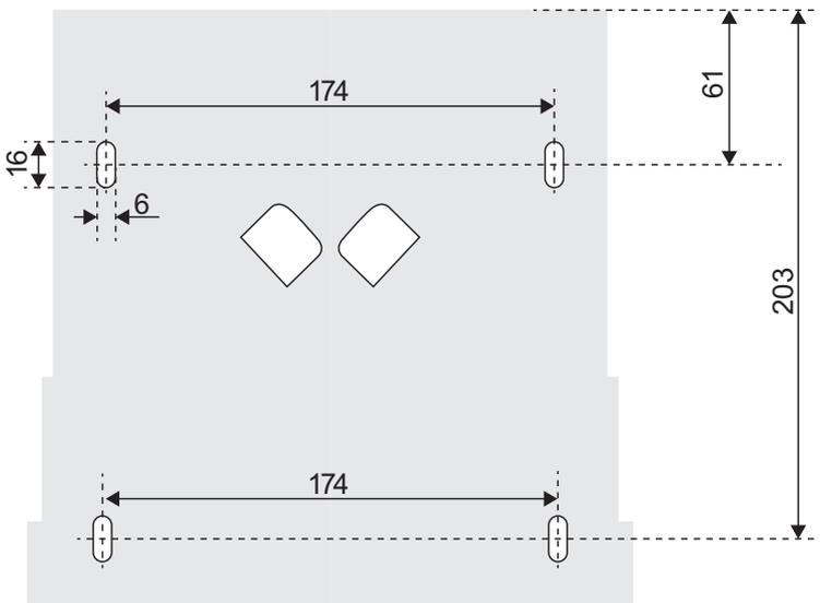
**Abmessungen und Montageskizze Profi-Umluft-Modul 2**
